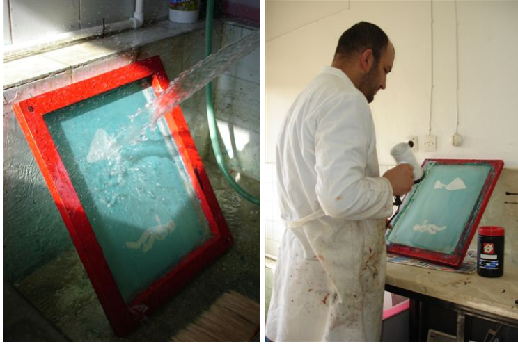
Fotoğraf 10: Hazırlanan İpek Kalıp Üzerindeki Dökülmesi Gereken Lakın Su ile Akıtılması ve Kalıbın Kurutulması.
