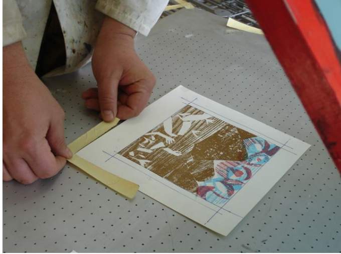
Fotoğraf 11: Basılacak 4. Renk İçin Resmin Serigrafi Masasına Yerleştirilmesi.
