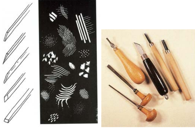
Fotoğraf 1: Kullanılan Oyma Bıçakları ve Onlarla Oluşturulan Dokular.
