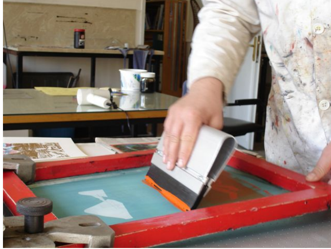
Fotoğraf 13: Ragle Yardımı ile Boyanın Kağıda Aktarılması.
